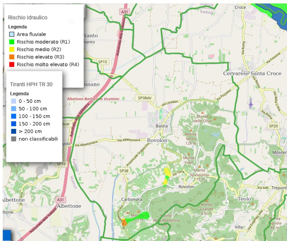
Fig. 47 Mappa del "Rischio idraulico" con Tempo di Ritorno 30 anni, elaborata nell'ambito del Piano di Gestione del Rischio Alluvioni – 2015-2021. Particolare del comune di Rovolon. (Fonte: Distretto Alpi Orientali)
