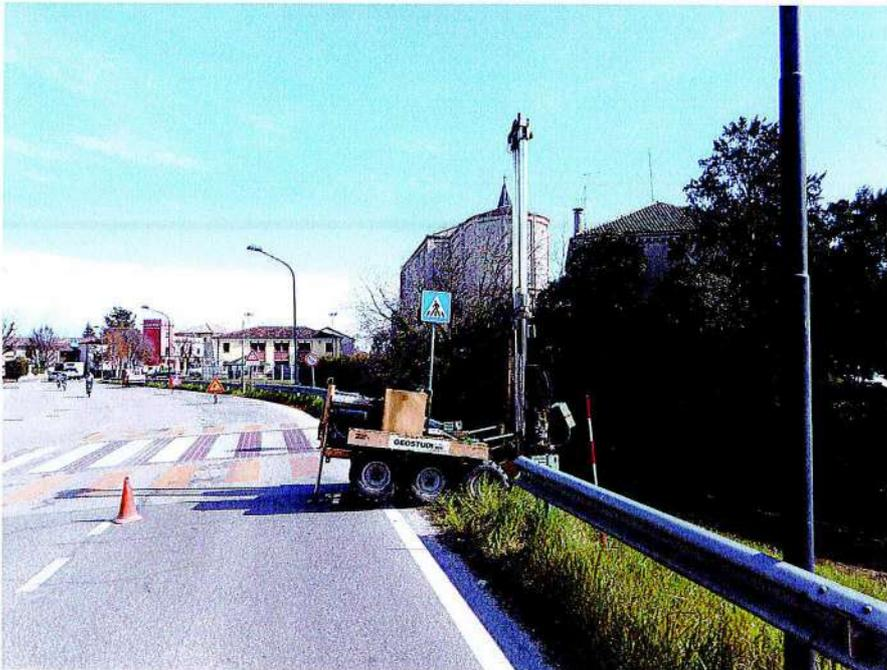
ESECUZIONE PROVA SISMICA MASW
