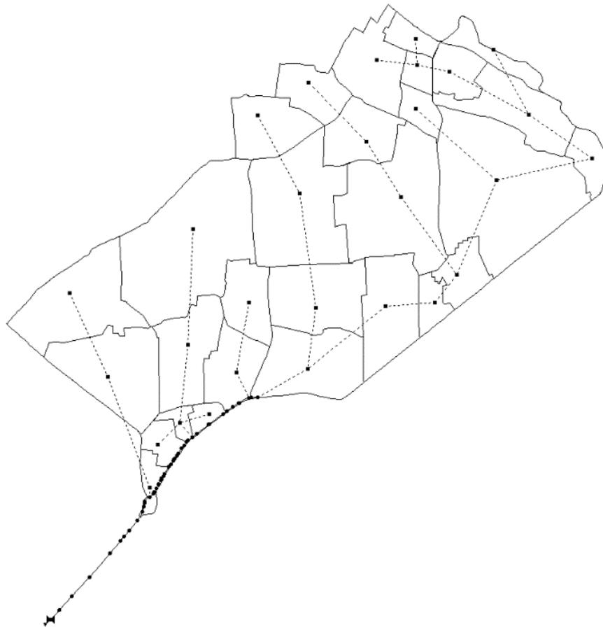
Fig. 8.1: Schematizzazione dei sottobacini e dello Scolo Fossona nel software EPA-SWMM
